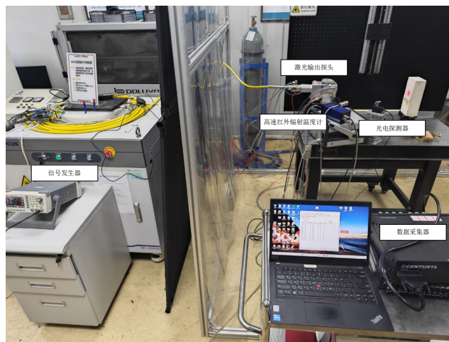
图5 高能激光恒温源系统搭建图
