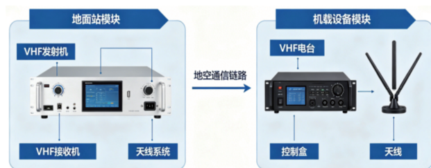
图 2 民航地空 VHF 通信系统构成
