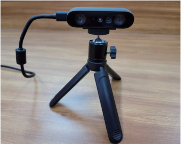
图 6 Orbbec Gemini 335 深度相机
