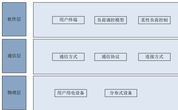
图 1 电力负荷智能调控架构图
