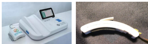
(a) 多通道脉搏波采集装置 (b) 复合式压力传感器
