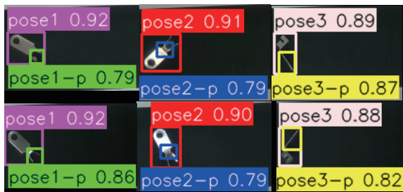
图 12 改进后 YOLOv8n 部分检测后的图像
