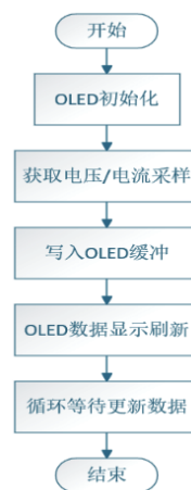
图 6 信息显示与交互系统控制流程图
