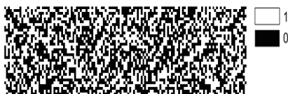
图 4 基于 Xilinx Zynq-7000 的 16 组 256 位 PUF 随机流
