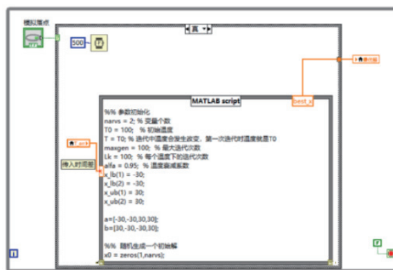
图 6 模拟退火算法的 LabVIEW 框图
