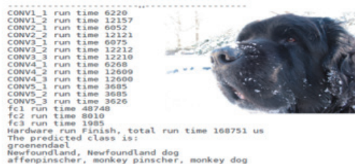
图 5 CNN 加速器的运算时间及识别结果
