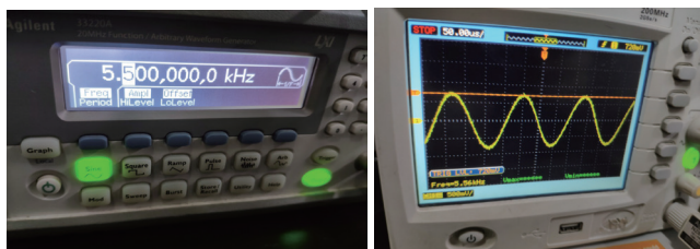
图 17 示波器显示的水听器信号和滤波后的信号
