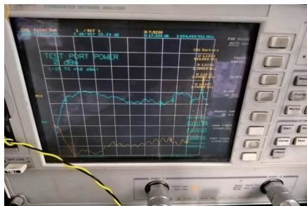
图 10 功率放大器实测小信号增益曲线
