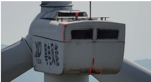
图 5 风机巡检缺陷结果
