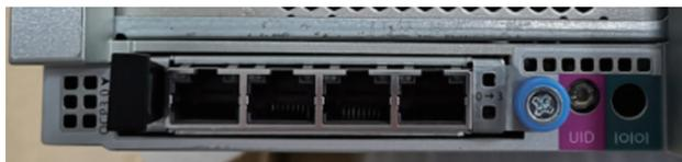
图3 服务器RJ45千兆网络接口
