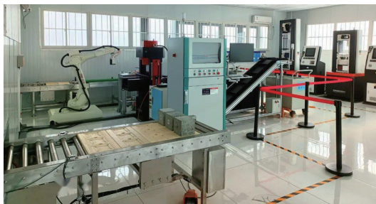
图 1 全自动智能混凝土养护抗压检测系统
