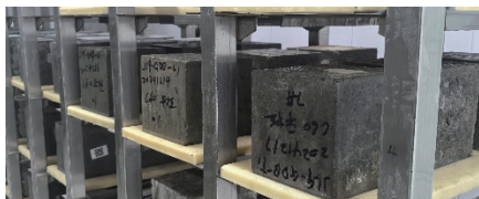
图5 养护后的混凝土试块
